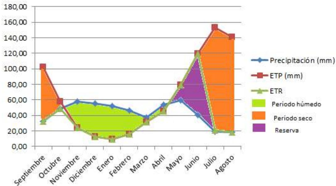
Fig.29. Balance hidráulico Cuenca Rio Cega.
