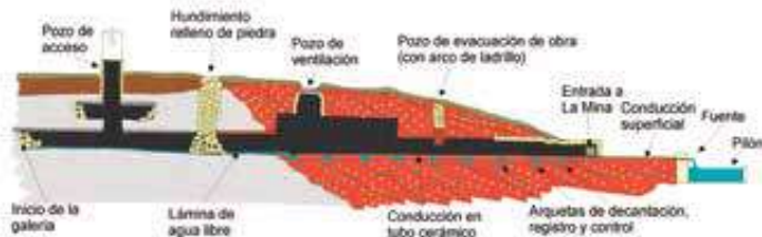
Arriba: corte geológico con los principales elementos de la Mina de Carbonero el Mayor.
